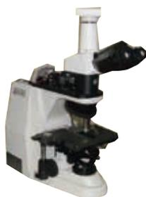
評価・計測 熱レンズ顕微鏡
