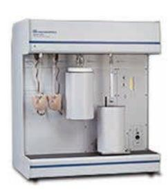
**評価・計測** 比表面積 / 細孔分布装置
