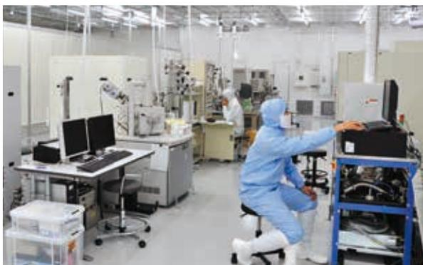
※クラス100は、1立方フィートの中に直径0.5μm以上の微粒子が100個以下、クラス10000は1万個以下のクリーン度を示す
