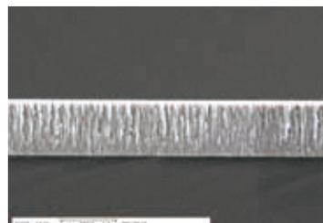
■二酸化シリコンSiO<sub>2</sub>のエッチング例
