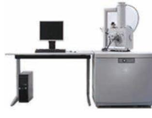
**評価・計測** 環境制御型電子顕微鏡
