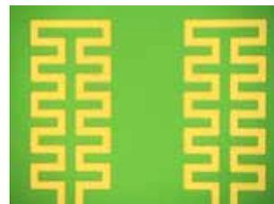
■図2 NiCr電極の拡大図(線幅は30 μm)
