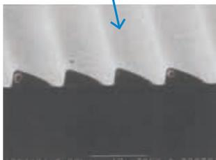
「ブレードグレーティング」。光学平面レンズに膜厚0.32 $\mu\text{m}$ 、ピッチ1.0 $\mu\text{m}$ で描画
